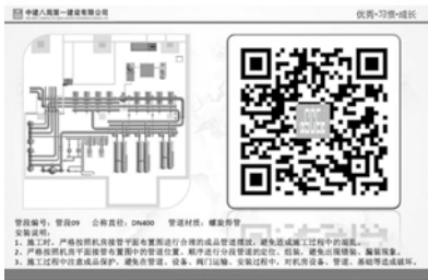
图6 分段管道二维码标识
