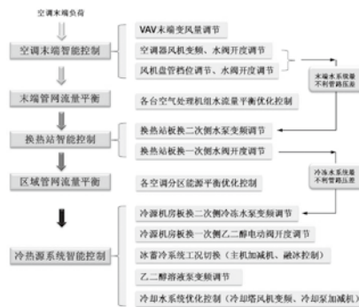
图9 “中国尊”空调系统控制逻辑关系示意图
