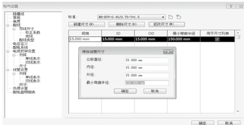
图1 设置电缆弯曲半径
