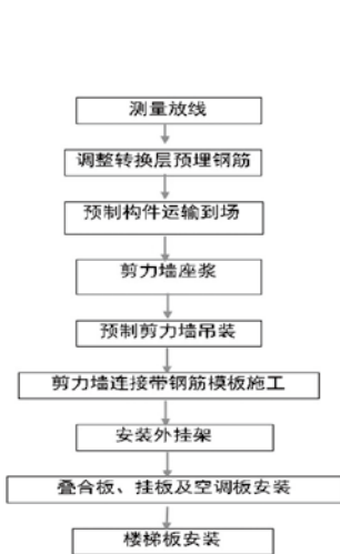
图3 预制构件吊装施工工艺流程
