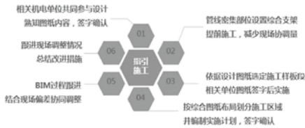
图1 BIM指引施工流程
