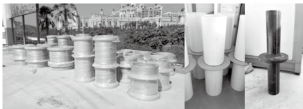
图1 直埋管道(左图:FRP直埋管道,中图:PVC直埋管道,右图:PE直埋管道)
