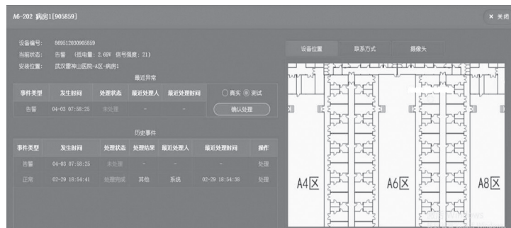
图4 无线烟感报警系统电脑版界面
